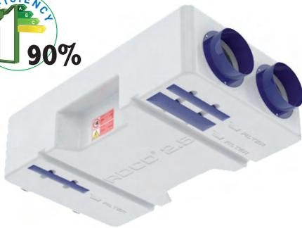
Unità di ventilazione con struttura autoportante in EPS a tenuta, completa di sistema estrazione filtri e drenaggio condensa; recuperatore di calore del tipo in controcorrente interamente realizzato in materiale plastico; ventilatori con motore EC brushless. Le unità sono provviste di serie con celle filtranti ondulate in fibra sintetica classe G4, ed in opzione un filtro a d'efficienza F7 su aria esterna. Sono disponibili tre livelli di regolazione.
